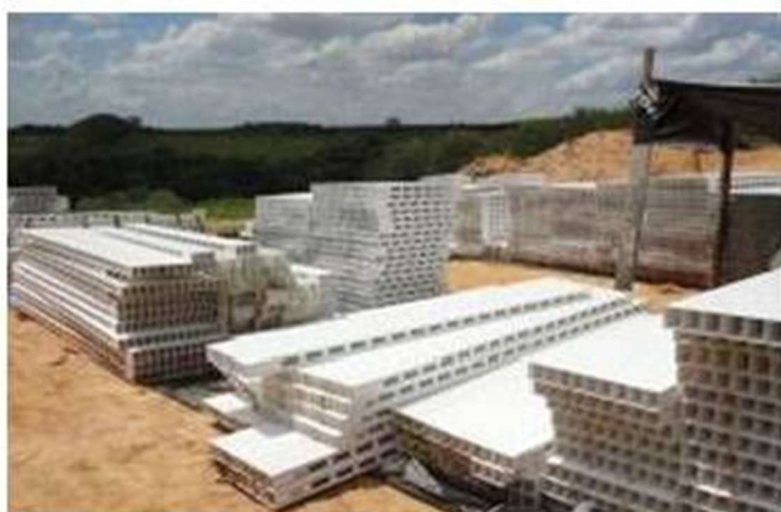
FIGURA 18 – Painéis de PVC pré-moldados na fábrica
