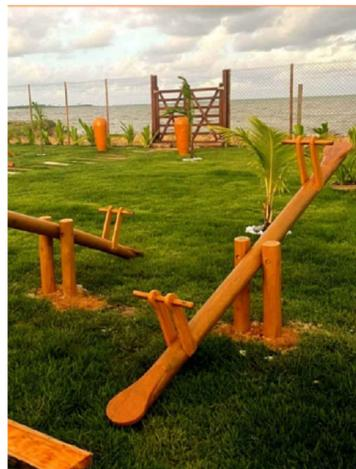
Gangorra construída com madeira de Eucalipto e Pinus autoclavado.
