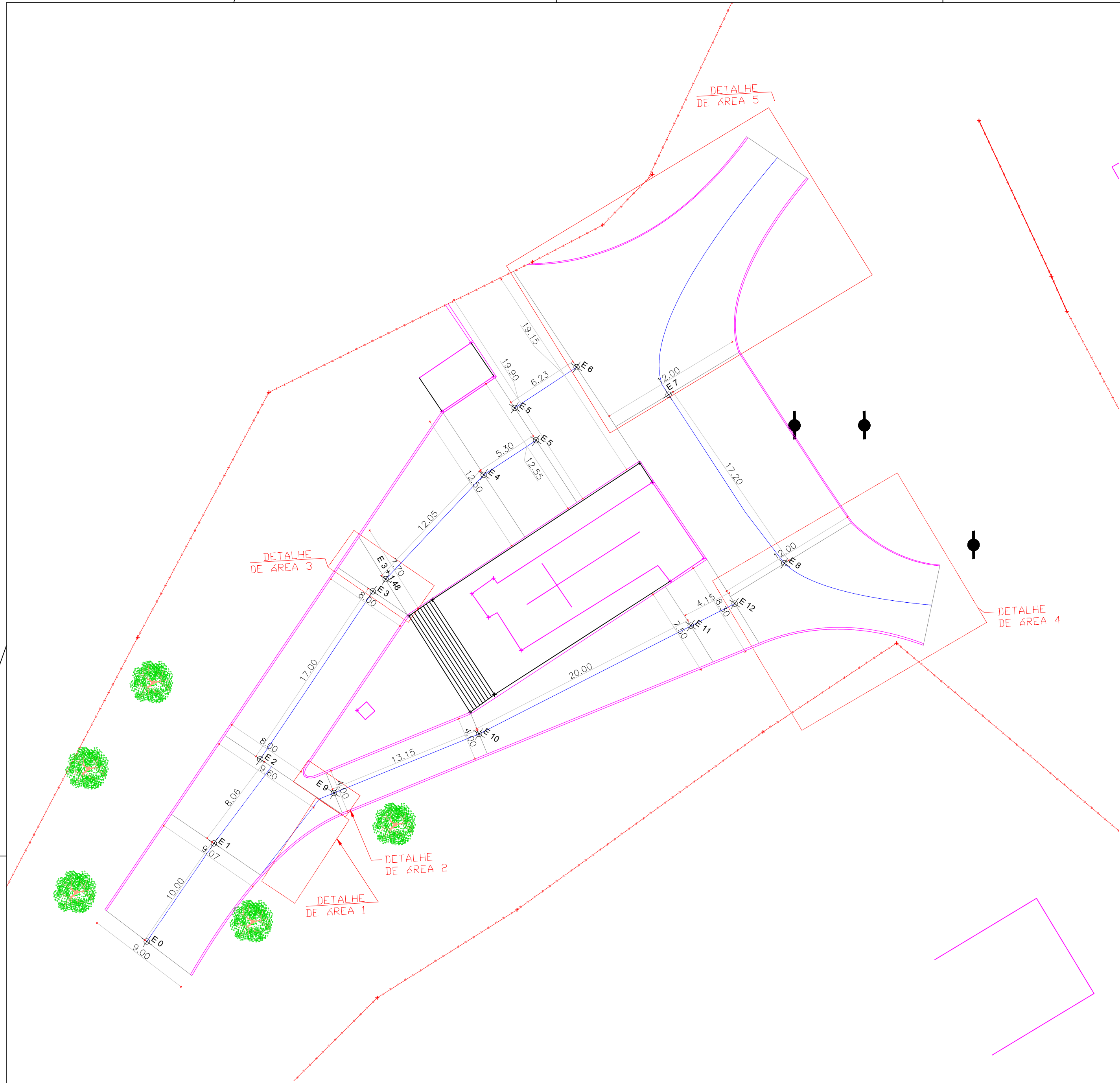
1 ESTAQUEAMENTO E DETALHES DE ÁREA ESCALA 1/150
