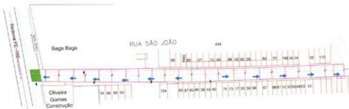
2 PLANTA DE DRENAGEM SUPERFICIAL ESCALA 1:500
