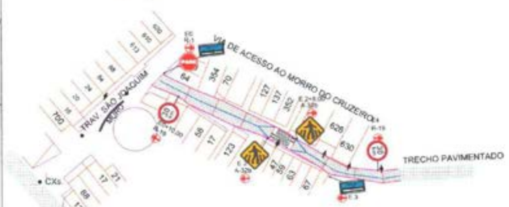
2 PLANTA DE PAVIMENTAÇÃO E SINALIZAÇÃO ESCALA 1:400
