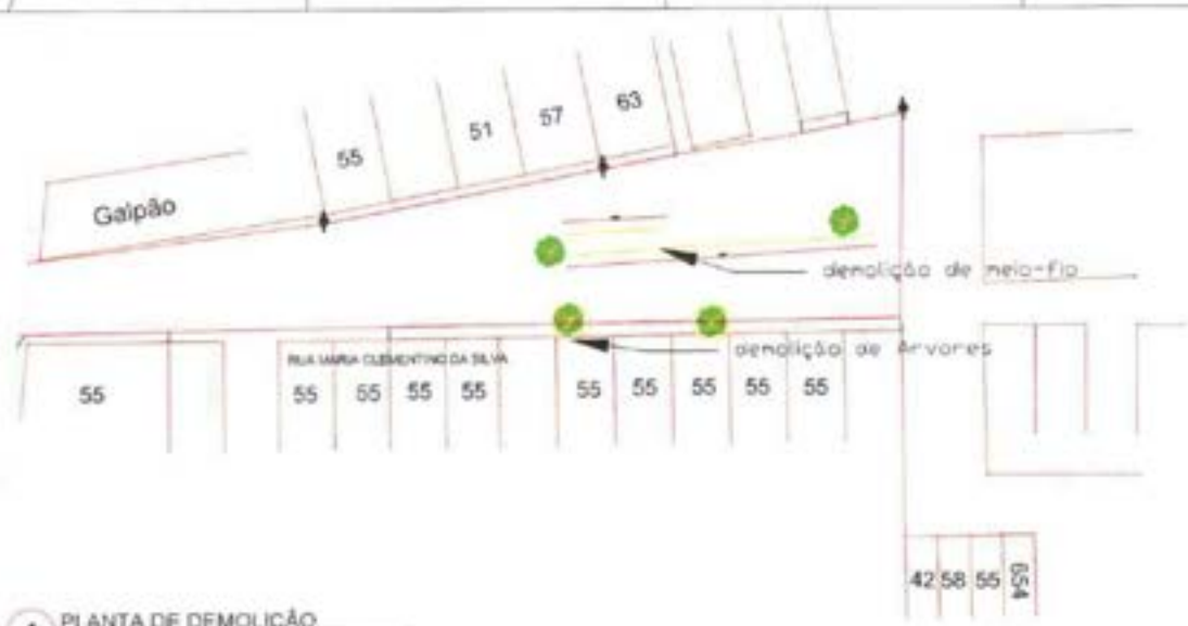
1 PLANTA DE DEMOLIÇÃO ESCALA 1/500
