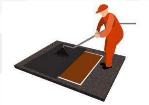
Figura 3 - Execução da Pintura de Ligação
